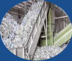
Transformation du PP en granulés exploitables en injection et en extrusion
