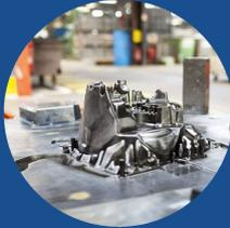
Unité de fabrication des composants aluminium par injection haute pression – principalement pour la production en série – et avec de nombreuses applications dans l'automobile – p.ex. boîtier aluminium de transmission de vitesses
