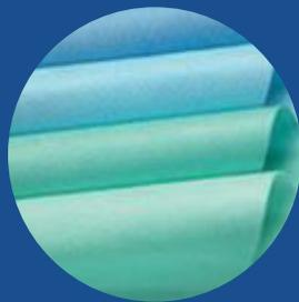
Fabrication de tissu non tissé SMS (spunbond + meltblown) utilisé dans les secteurs de la santé et de l'hygiène pour ses propriétés stériles, car il est doux et neutre pour la peau et car il dispose d'une grande résistance longitudinale et transversale. Des traitements spécifiques lui confèrent des caractéristiques additionnelles (e.g. hydrophile, antibactérien)
