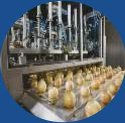
Transformation et valorisation de l'oignon en produit conditionné prêt à l'emploi, tranché ou en poudres, utilisées dans les préparations culinaires. Le procédé de fabrication comprend notamment l'épluchage / découpage, voire séchage, broyage et conditionnement
